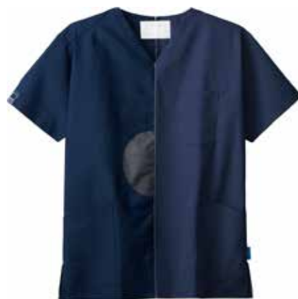
塩素系漂白剤を使った実験 左:通常のカラースクラブ 右:「ジアスクラブ®」 通常のカラースクラブでは色抜けが見られるが、「ジアスクラブ®」は色落ちしていない。
